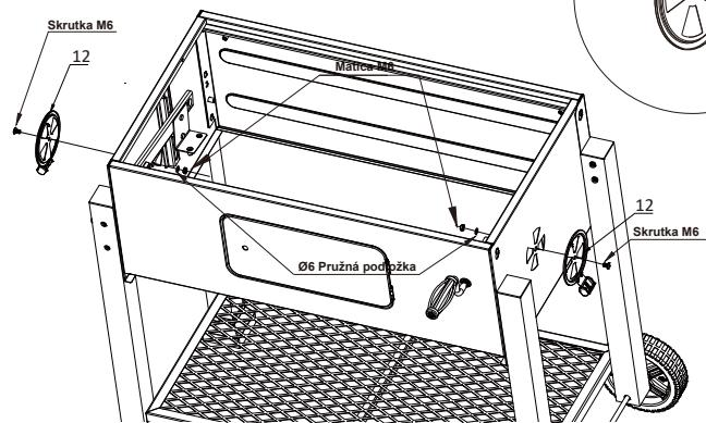
Pripevnite klapku na kúrenisko pomocou vopred namontovanej skrutky, podložky a matice.
