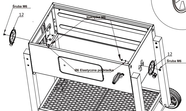
Przymocuj klapę do paleniska za pomocą zamontowanej śruby, podkładki i nakrętki.
