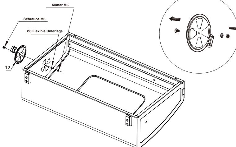
Befestigen Sie die Klappe mit der vormontierter Schraube, Unterlegscheibe und Mutter am Deckel.
