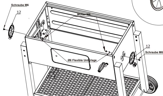
Befestigen Sie die Klappe mit der vormontierten Schraube, Unterlegscheibe und Mutter am Feuerraum.
