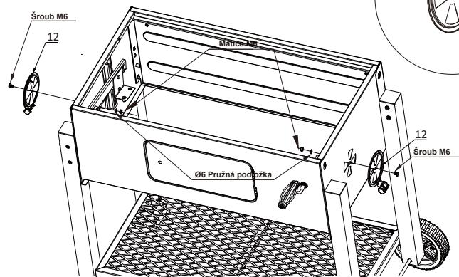
Připevněte klapku na topeniště pomocí předem namontovaného šroubu, podložky a matice.
