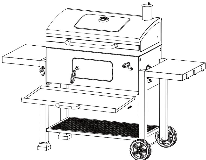
Befestigen Sie den Ascheschale-Griff mit den vormontierten Schrauben an der Aschenschale.
