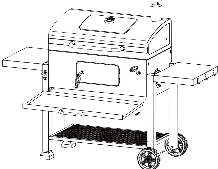
Připevněte rukojet' popelníku k popelníku pomocí předem namontovaných šroubů.
