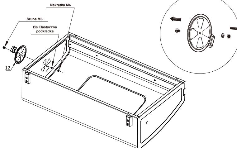
Zamocuj klapę na pokrywie za pomocą zamontowanej śruby, podkładki i nakrętki.
