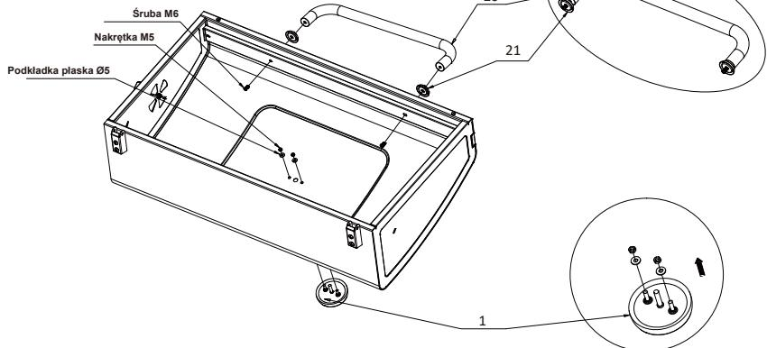
Zamocuj uchwyt osłony i termometr na pokrywie za pomocą wstępnie zainstalowanych śrub, podkładek i nakrętek.
