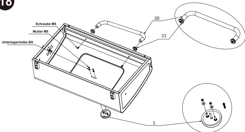
Befestigen Sie den Griff des Deckels und die Temperaturanzeige den vormontierten Schrauben, Unterlegscheiben und Muttern am Deckel.
