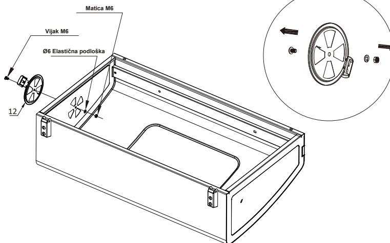
Pričvrstite klapnu na poklopcu pomoću prethodno instaliranog vijka, podloške i maticice.
