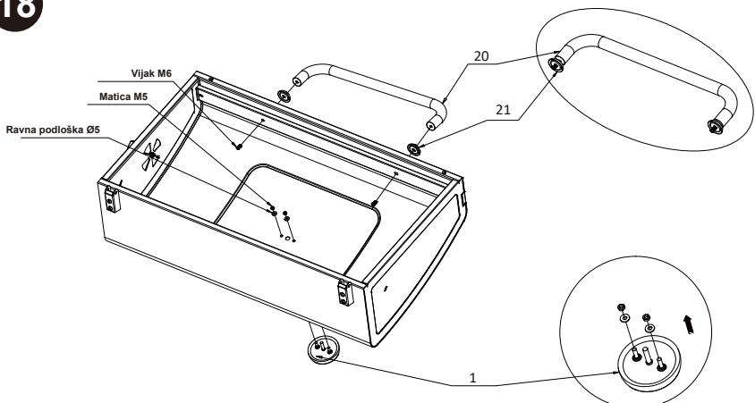
Pričvrstite ručku poklopca i termometar na poklopac pomoću prethodno instaliranih vijaka, podloški i matica.
