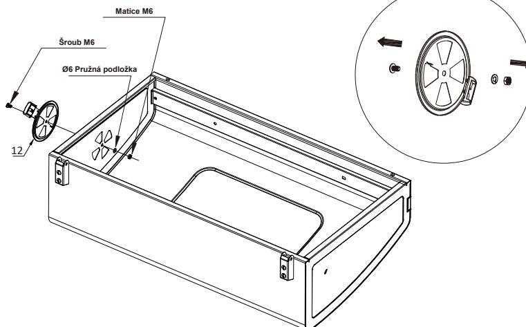
Zajistěte klapku na víku pomocí předem namontovaného šroubu, podložky a matice.
