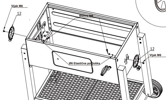
Pričvrstite klapnu na ložište pomoću prethodno instaliranog vijka, podloške i maticice.
