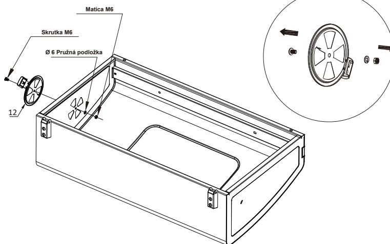
Zaistite klapku na veku pomocou vopred namontovanej skrutky, podložky a matice.
