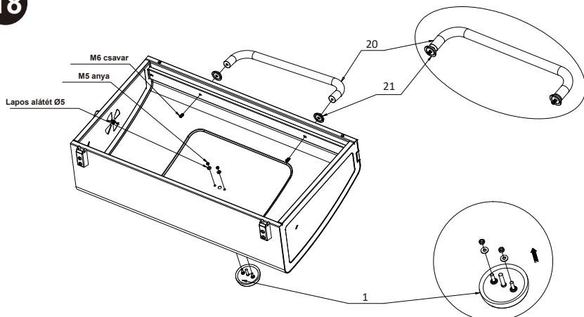
Rögzítse a fedél fogantyúját és a hőmérőt a fedélhez az előre beszerelt csavarokkal, alátétekkel és anyákkal.
