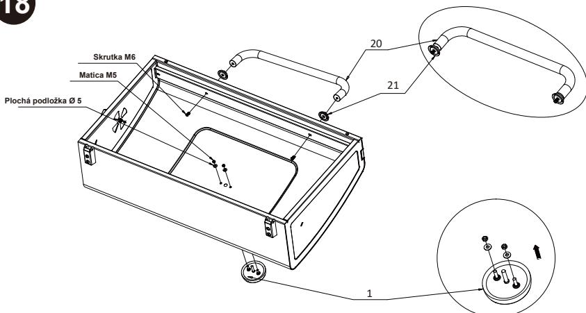
Zaistite rukoväť krytu a teplomer na veku pomocou vopred namontovaných skrutiek, podložiek a matíc.
