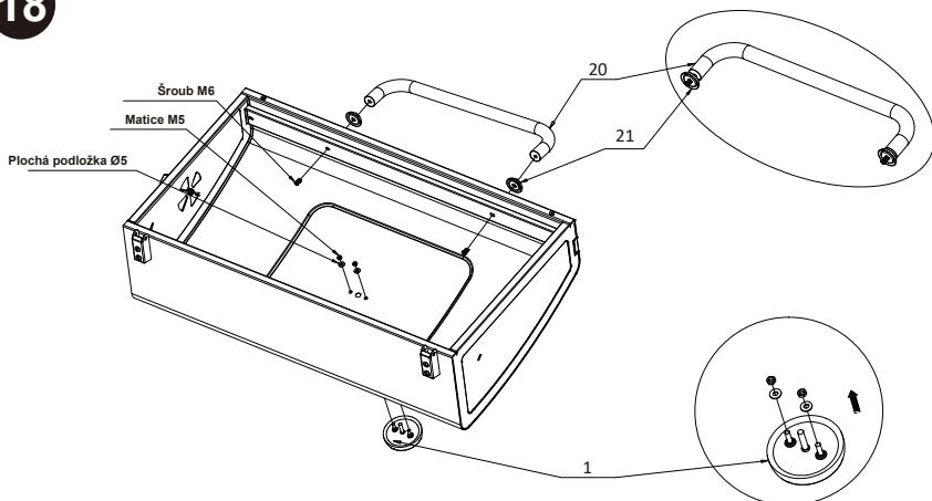
Zajistěte rukojeť krytu a teploměr na víku pomocí předem namontovaných šroubů, podložek a matic.
