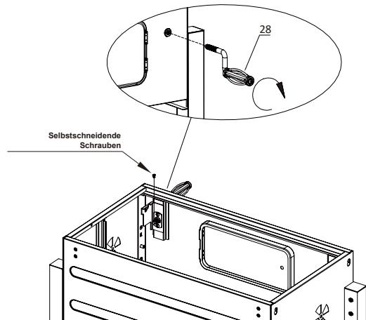
Bemerkung: Achten Sie darauf, dass sich die Kurbel bis zum Ende gegen den Uhrzeigersinn drehen lässt.
